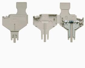
コンポーネントプラグは、電子コンポーネントを接続断路端子台に統合するために使用されます。電子コンポーネントのはんだ付け後、プラグを接続断路端子台の断路箇所に組み込むことで、断路端子台を電子コンポーネント内蔵型のモジューラー端子台に変更します。
