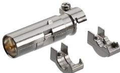
ConCept-CSB モジュールはダブルモジュールで、ConCept モジュールフレームのふたつのスロットを取り付けます。ConCept-CSB モジュールは、ふたつのコンタクトキャリアを保持可能なモジュールキャリアで構成されます。コンタクトキャリアは、優れたシールド性能を有する鋳造亜鉛合金で製造されています。クリンプ接点は、コンタクトキャリアから絶縁され、プラスチックインサートに取り付けられます。さまざまな極数（1極、4極、8極）を使用して、幅広いアプリケーションとの互換性を確保できます。
