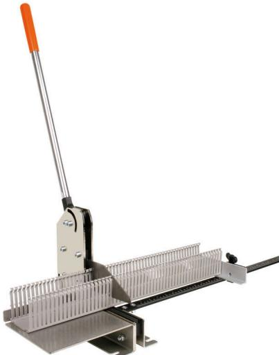
配線ダクトカッターは、配線チャネルを手動で切断するために使用し、最大 125 mm 幅と 2.5 mm 厚壁に対応します。フィラーによって非強化プラスチックのみに適用されます。
