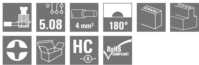
配線を直線 (180°) の接続方向に接続対応の、クランプヨークねじシステム搭載メス型プラグ。メス型コネクタは、マーキングスペースがあり、識別表示が可能です。フランジまたはリリースラッチで固定します。また、プラス/マイナスネジが組込まれたクランプヨークは、電線の誤挿入防止機能を有し、クランプは開いた状態で納入されます。HC = 高電流。
