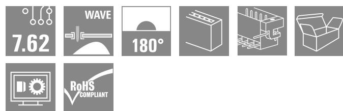
7.62 ピッチの PCB 対応 180° メス側ヘッダー。IEC 61800-5-1 準拠、および UL840 600 V 認証取得。電力出力や中間回路のアプリケーションに最適なタッチセーフソリューション。
