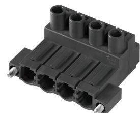
ピッチ 7.62、2.5 mm<sup>2</sup> のフィールド配線対応クランピングヨーク接続付属 180° 逆オス型ヘッダー。また、逆電圧のタッチセーフソリューションとしても最適です。UL1059 600 V クラス C および IEC 61800-5-1 の要件を満たします。
