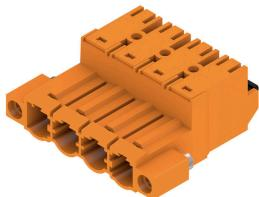
2.5mm<sup>2</sup>、7.62 ピッチのフィールド配線対応のプッシュイン接続技術を採用した 180° オス型ヘッダ。また、逆電圧のタッチセーフソリューションとしても最適です。UL1059 600 V クラス C および IEC 61800-5-1 の要件を満たします。
