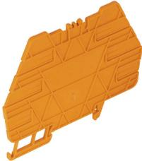
汎用性の高い分離プレートより良好な全体状況のために、分離プレートは、視覚的に信号をまとめたり、モジュールを電氣的に絶縁したり、マーキングを挿入するように使用されます。これにより、それらは特に汎用性の高いアクセサリとなります。分離プレートにより、2つのモジュール間の空気パスおよびクリープパスが増加し、2つのモジュール間の定格絶縁電圧が最大600 Vに増加します。二重分離プレートには WAD5 または WS10/5 マーカーを表示し、継続的な渡り配線を可能にします。渡り配線チャンネルを個別に分割するための通気孔により、設置が容易になります。
