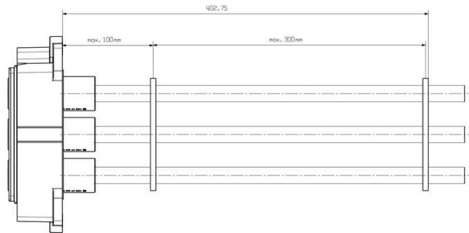
接点や絶縁スリープへの損傷を避けるため、ケーブルの修正を推奨します。次の図面に対応する距離を示します。ケーブル固定は出荷の範囲に含まれません。
