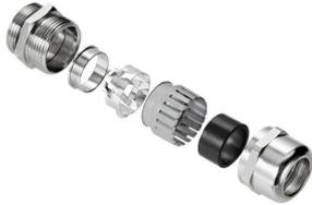
電子部品の感度の向上と電磁干渉周波数の増加により、ケーブルグラウンドはシステムの外装コンセプトにおいて重要な役割を果たす必要があります。この種別の EMC ケーブルグラウンドは、360°のスクリーニング接続で、干渉周波数に対する遮蔽を目的に作成されています。フィンガーロックシールは、優れたケーブル保持とケーブル負荷解放部品を提供し、ケーブルグラウンドは EN 62444 の機械的要件に準拠します。特許取得済形状により、非常に簡単に高速な組み立てが可能になります。
