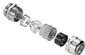
電子部品の感度の向上と電磁干渉周波数の増加により、ケーブルグランドはシステムの外装コンセプトにおいて重要な役割を果たす必要があります。この種別の EMC ケーブルグランドは、360 のスクリーニング接続で、干渉周波数に対する遮蔽を目的に作成されています。フィンガーロックシールは、優れたケーブル保持とケーブル負荷解放部品を提供し、ケーブルグランドは EN 62444 の機械的要件に準拠します。特許取得済形状により、非常に簡単に高速な組み立てが可能になります。
