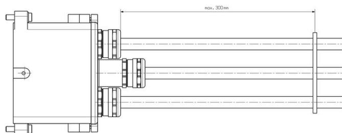
接点や絶縁スリーブへの損傷を避けるため、ケーブルの修正を推奨します。次の図面に対応する距離を示します。ケーブル固定は出荷の範囲に含まれません。
