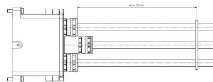
接点や絶縁スリープへの損傷を避けるため、ケーブルの修正を推奨します。次の図面に対応する距離を示します。ケーブル固定は出荷の範囲に含まれません。
