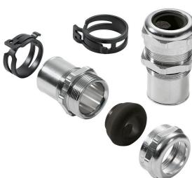
電子部品の感度の向上と電磁干渉周波数の増加により、ケーブルグランドはシステムの外装コンセプトにおいて重要な役割を果たす必要があります。この種別のEMCケーブルグランドは、360°のスクリーニング接続で、干渉周波数に対する遮蔽を目的に作成されています。フィンガーロックシールは、優れたケーブル保持とケーブル負荷解放部品を提供し、ケーブルグランドはEN 62444の機械的要件に準拠します。特許取得済形状により、非常に簡単で高速な組み立てが可能になります。
