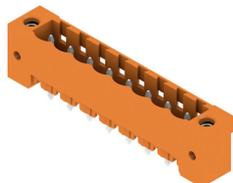
グラスファイバー強化プラスチック製ピンヘッド、ストレート電線引き出し口、フローはんだ付け用に最適化されています。フランジ (F) は、各相手側コネクタや回路基板とネジ固定できます。はんだフランジ (LF) バージョンを使用すれば基板への補助固定にネジ作業を必要としません。また、機械的な歪みからはんだ付け箇所を保護することもできます。すべてのピンヘッドは、マニュアルでコーディングすることも、コーディング済みのものをご注文いただくことも可能です。HC = 高電流。
