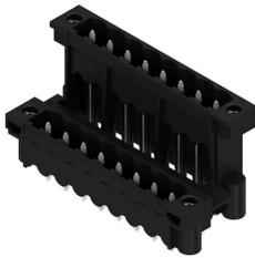
高耐熱性、二段階型、水平オフセット、フランジ付属オス型コネクタまたは、はんだフランジ。リフローはんだ付け適合 1.5 mm ソルダピン。リフローおよびフローはんだ付け適合3.2mmはんだピン。ピンヘッダは、マーキングスペースがあり、識別表示が可能です。
