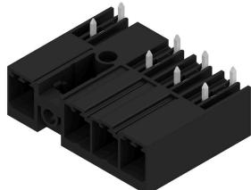
7.62 ピッチのミドルフランジ付属 270° オス型ヘッダー。IEC 61800-5-1 の要件を満たし、UL840 600 V に準拠して UL 認証取得が可能です。メス側ヘッダーがない場合、接合プロファイルは、テストフィンガーに 20 N 以上の圧力を 3 mm 以上のを保証。
