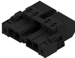
ハウジング通路用の「3 フランジバリアント」 6 mm<sup>2</sup>、7.62 ピッチのフィールド配線対応のプッシュイン接続技術採用の 180° 反転オス型ヘッダー。最大壁厚 2mm のハウジングに取り付け可能です。電圧のかかっている接続部のフィンガーセーフ・ソリューションとしても最適です。UL1059 600 V クラス C および IEC 61800-5-1 の要件を満たします。
