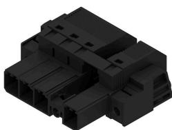
ハウジング通路用の「3 フランジバリエント」 6 mm<sup>2</sup>、7.62 ピッチのフィールド配線対応のプッシュイン接続技術採用の 180° 反転オス型ヘッダー。最大壁厚 16 mm のハウジングに適しています。
