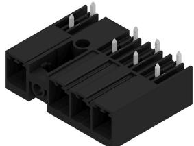
7.62 ピッチのミドルフランジ付属 270° オス型ヘッダー。IEC 61800-5-1 の要件を満たし、UL840 600 V に準拠して UL 認証取得が可能です。メス側ヘッダーがない場合、接合プロファイルは、テストフィンガーに 20 N 以上の圧力で 3 mm 以上のを保証。
