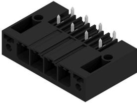
単列、高電流および高性能オス型ヘッダは電極を犠牲にすることなく整列状態に取り付けることができます。また、ツール不要ですばやく固定するためのフランジが付属します。誤接防止の接合プロファイル、独自の多様なコーディング、誤配線防止機能、およびフランジへの追加締め付け、最大の接続性と動作信頼性を実現します。
