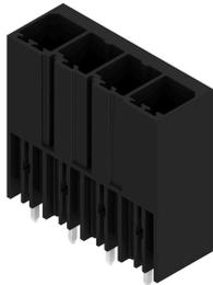
電極を犠牲にすることなく、またはツールを使わずに高速に整列状態で固定できる特許取得済みのフランジを備えた、単列で高性能なオス型ヘッダー。接合プロファイルにより、固有に識別可能なコーディング多様性およびフランジへの追加締め付けにより、誤接を防止し、接続性と動作信頼性が最大限に向上します。3.5 mmのピン長は、鉛フリーのウェーブはんだ付けに最適化されています。
