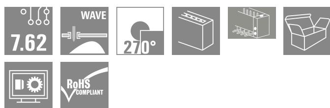
7.62 ピッチのミドルフランジ付属 270° オス型ヘッダー。IEC 61800-5-1 の要件を満たし、UL840 600 V に準拠して UL 認証取得が可能です。メス側ヘッダーがない場合、接合プロファイルは、テストフィンガーに 20 N 以上の圧力で 3 mm 以上のを保証。
