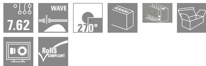
7.62 ピッチのミドルフランジ付属 270° オス型ヘッダー。IEC 61800-5-1 の要件を満たし、UL840 600 V に準拠して UL 認証取得が可能です。メス側ヘッダーがない場合、接合プロファイルは、テストフィンガーに 20 N 以上の圧力で 3 mm 以上のを保証。
