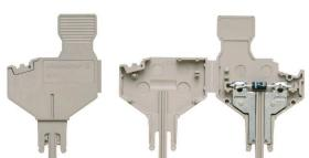
コンポーネントプラグは、電子コンポーネントを接続断路端子台に統合するために使用されます。電子コンポーネントのはんだ付け後、プラグを接続断路端子台の断路箇所に組み込むことで、断路端子台を電子コンポーネント内蔵型のモジューラー端子台に変更します。
