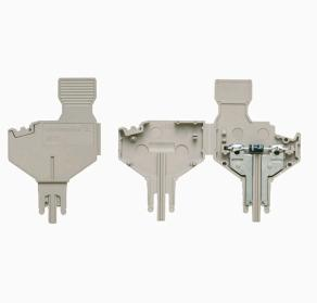
コンポーネントプラグは、電子コンポーネントを接続断路端子台に統合するために使用されます。電子コンポーネントのはんだ付け後、プラグを接続断路端子台の断路箇所に組み込むことで、断路端子台を電子コンポーネント内蔵型のモジューラー端子台に変更します。
