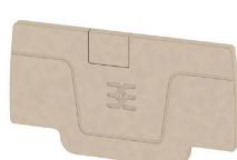
エンドプラケット前の最終モジュラ端子台の開口側に、エンドプレートが取り付けられます。エンドプレートの使用は、モジュラ端子台の機能、および指定の定格電圧を保証します。通電部品との接触を防ぎ、最終的な端子に指で触れないようにします。
