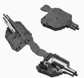
ヒューズホルダー SIHAは、断路端子をヒューズ端子に素早く切り替えます。断路レバーをそのまま取り外してヒューズユニットを取り付けます。
