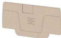
エンドブラケット前の最終モジュラ端子台の開口側に、エンドプレートが取り付けられます。エンドプレートの使用は、モジュラ端子台の機能、および指定の定格電圧を保証します。通電部品との接触を防ぎ、最終的な端子に指で触れないようにします。
