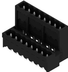
高耐熱性、二段階型、数位閉オフセット、閉鎖端部オス型ヘッダー、はんだ付けフランジオプション付属。リフローはんだ付け対応 1.5 mm ソルダーピン。リフローおよびウェーブはんだ付け適合3.2 mm ソルダーピン。ピンヘッダは、マーキングスペースがあり、識別表示が可能です。。
