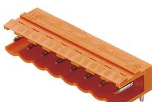
90°の取り出し方向のオス型コネクタ。はんだピンの長さは、フローはんだ付けに適した長さになっています。ピンヘッダーは、マーキングスペースがあり、識別表示が可能です。
