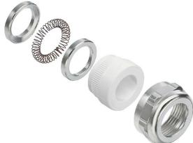
電子部品の感度の向上と電磁干渉周波数の増加により、ケーブルグランドはシステムの外装コンセプトにおいて重要な役割を果たす必要があります。この種別の EMC ケーブルグランドは、360 のスクリーニング接続で、干渉周波数に対する遮蔽を目的に作成されています。フィンガーロックシールは、優れたケーブル保持とケーブル負荷解放部品を提供し、ケーブルグランドは EN 62444 の機械的要件に準拠します。特許取得済形状により、非常に簡単で高速な組み立てが可能になります。
