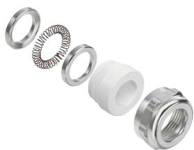
電子部品の感度の向上と電磁干渉周波数の増加により、ケーブルグランドはシステムの外装コンセプトにおいて重要な役割を果たす必要があります。この種別の EMC ケーブルグランドは、360 のスクリーニング接続で、干渉周波数に対する遮蔽を目的に作成されています。フィンガーロックシールは、優れたケーブル保持とケーブル負荷解放部品を提供し、ケーブルグランドは EN 62444 の機械的要件に準拠します。特許取得済形状により、非常に簡単で高速な組み立てが可能になります。
