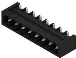
高耐熱性、直線、開いたピンヘッダー。箱もしくはテープ梱包。1.5 mm のソルダピンを備えたテープ上で、自動機実装に最適化。リフローおよびウェーブはんだ付け適合3.2 mm ソルダピン。ピンヘッダは、マーキングスペースがあり、識別表示が可能です。HC = 高電流。
