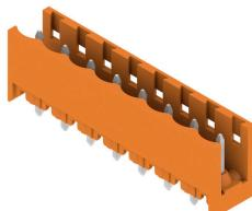
グラスファイバー強化プラスチック製ピンヘッダ、ストレート電線引き出し口、フローはんだ付け用に最適化されています。フランジ (F) は、各相手側コネクタや回路基板とネジ固定できます。はんだフランジ (LF) バージョンを使用すれば基板への補助固定にネジ作業を必要としません。また、機械的な歪みからはんだ付け箇所を保護することもできます。すべてのピンヘッダは、マニュアルでコーディングすることも、コーディング済みのものをご注文いただくことも可能です。HC = 高電流。
