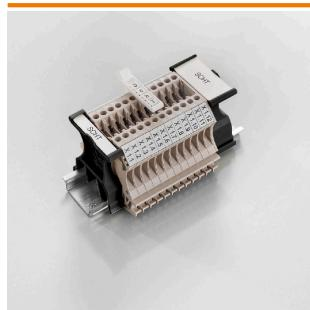
CHT 5 S グループタグキャリアは、TS 32 取り付けレール (G レール) または TS 35 取付レール (トップハットレール) に直接クリップ固定されています。したがって、端子とその種別に関係なく、端子ストリップにラベリングを実施できます。SchT 5 と SchT 5S には、ESO 5、STR 5 保護ストリップが取り付けられています。SchT 7 は、クランプネジに容易にアクセス可能な差し込み板対応のヒンジ付属グループタグキャリアです。SchT 7 には、ESO 7、STR 7 の保護ストリップまたはDEK 5 が取り付けられています。差し込み板および保護ストリップは、「アクセサリ」の下にあります。
