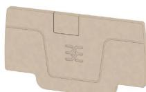
分離プレートとエンドプレートは端子台にとって不可欠なアクセサリです。分離プレートは、異なる電位や機能グループを光学的および電気的に分離し、安全性を高め、制御盤内部の構造を明確にします。エンドプレートは端子台列の側面を閉じ、通電部分との接触を防ぎ、清潔で安定した仕上がりを確保します。どちらのコンポーネントも、それぞれのWeidmüller端子台モデルシリーズには正確に適合しており、安全でコンプライアンスに準拠したプロフェッショナルな配線に役立ちます。
