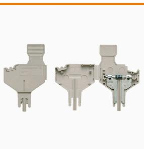
コンポーネントプラグは、電子コンポーネントを接続断路端子台に統合するために使用されます。電子コンポーネントのはんだ付け後、プラグを接続断路端子台の断路箇所に組み込むことで、断路端子台を電子コンポーネント内蔵型のモジューラー端子台に変更します。
