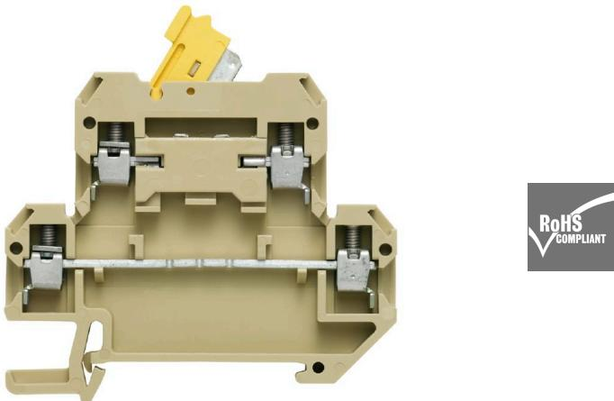
一部の用途では、テストや安全の目的で、テストポイントまたは断路要素をフィードスルー端子に追加することが妥当です。テスト断路端子を使用すれば、無電圧状態で電流回路を測定できます。断路中、空気パスおよびクリープパスの寸法は評価されませんが、指定の定格突入電圧の強度を確認する必要があります。
