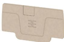
分離プレートとエンドプレートは端子台にとって不可欠なアクセサリです。分離プレートは、異なる電位や機能グループを光学的および電気的に分離し、安全性を高め、制御盤内部の構造を明確にします。エンドプレートは端子台列の側面を閉じ、通電部分との接触を防ぎ、清潔で安定した仕上がりを確保します。どちらのコンポーネントも、それぞれのWeidmüller端子台モデルシリーズに正確に適合しており、安全でコンプライアンスに準拠したプロフェッショナルな配線に役立ちます。
