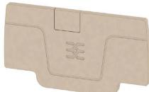
分離プレートとエンドプレートは端子台にとって不可欠なアクセサリです。分離プレートは、異なる電位や機能グループを光学的および電気的に分離し、安全性を高め、制御盤内部の構造を明確にします。エンドプレートは端子台列の側面を閉じ、通電部分との接触を防ぎ、清潔で安定した仕上がりを確保します。どちらのコンポーネントも、それぞれのWeidmüller端子台モデルシリーズに正確に適合しており、安全でコンプライアンスに準拠したプロフェッショナルな配線に役立ちます。
