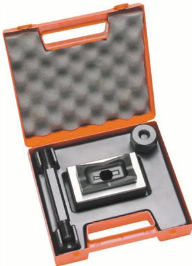
Per realizzare delle aperture nel vostro quadro elettrico gli utensili di foratura Weidmüller sono la scelta ideale.
