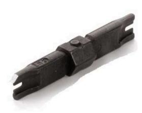
Utensile di compressione per doppini twistati Diversi tipi di lame per pin-board
