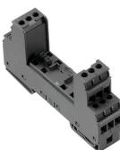
Elemento di base per gli scaricatori innestabili VSPC, piedino PE integrato nello zoccolo VSPC BASE, in grado di collegare a PE fino a 20 kA (8/20  $\mu$ s) e 2,5 kA (10/350  $\mu$ s) in modo sicuro.
