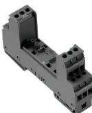
Elemento base per gli scaricatori innestabili VSPC. Piedino PE integrato nella base del modulo VSPC BASE senza impedenza e collegamento PE senza massa (FG) tramite lo spinterometro integrato in grado di collegare a PE fino a 20 kA (8/20 µs) e 2,5 kA (10/350 µs) in modo sicuro. Adatto per circuiti di segnale privi di messa a terra.
