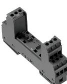
Elemento base per gli scaricatori innestabili VSPC. Piedino PE integrato nella base del modulo VSPC BASE senza impedenza e collegamento PE senza massa (FG) tramite lo spinterometro integrato in grado di collegare a PE fino a 20 kA (8/20 µs) e 2,5 kA (10/350 µs) in modo sicuro. Adatto per circuiti di segnale privi di messa a terra.
