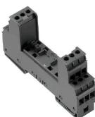
Elemento base per gli scaricatori innestabili VSPC. Piedino PE integrato nella base del modulo VSPC BASE senza impedenza e collegamento PE senza massa (FG) tramite lo spinterometro integrato in grado di collegare a PE fino a 20 kA (8/20  $\mu$ s) e 2,5 kA (10/350  $\mu$ s) in modo sicuro. Adatto per circuiti di segnale privi di messa a terra.
