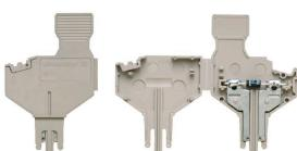
La spina per componenti viene utilizzata per integrare un componente elettronico in una morsettiera di sezionamento. Dopo aver saldato il componente elettronico, la spina può essere integrata nell'area di disconnessione dei nostri morsetti sezionatori e quindi cambia il morsetto sezionatore in un morsetto modulare con componente elettronico integrato.
