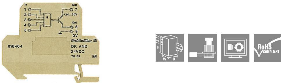
Funzioni logiche AND, NAND, OR e NOR in formato morsetto componibile con una sezione nominale di 4 mm<sup>2</sup>. Dispongono di 5 ingressi in collegamento logico con un'uscita 24 V/ 20 mA PNP. I moduli con funzioni logiche offrono un ampio spettro di applicazioni per l'accoppiamento di segnali digitali da sensori/attuatori con apparecchi d'automazione.
