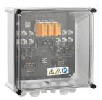
I combiner box fotovoltaici successivi per inverter con 1-12 tracker MPP sono utilizzati per proteggere il lato DC di un sistema fotovoltaico. I combiner box proteggono l'inverter dalle sovratensioni e sono quindi conformi alla direttiva europea CLC/TS 51643-32. Inoltre, questi prodotti offrono la possibilità di proteggere il sistema dalle correnti invertite e di combinare stringhe per garantire un risparmio di cavi durante l'installazione.
