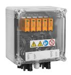
I combiner box fotovoltaici successivi per inverter con 1-12 tracker MPP sono utilizzati per proteggere il lato DC di un sistema fotovoltaico. I combiner box proteggono l'inverter dalle sovratensioni e sono quindi conformi alla direttiva europea CLC/TS 51643-32. Inoltre, questi prodotti offrono la possibilità di proteggere il sistema dalle correnti invertite e di combinare stringhe per garantire un risparmio di cavi durante l'installazione.
