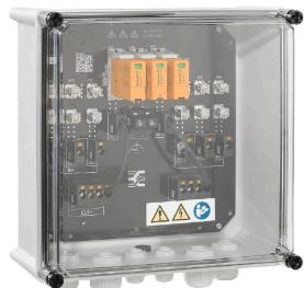
I combiner box fotovoltaici successivi per inverter con 1-12 tracker MPP sono utilizzati per proteggere il lato DC di un sistema fotovoltaico. I combiner box proteggono l'inverter dalle sovratensioni e sono quindi conformi alla direttiva europea CLC/TS 51643-32. Inoltre, questi prodotti offrono la possibilità di proteggere il sistema dalle correnti invertite e di combinare stringhe per garantire un risparmio di cavi durante l'installazione.
