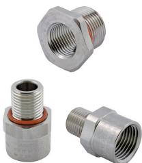
Gli adattatori della serie ADAP garantiscono flessibilità e versatilità per il riempimento di ingressi non utilizzati nelle attrezzature Ex pur mantenendo una protezione a prova di fiamma Ex d, una protezione contro le esplosioni a sicurezza aumentata Ex e un grado di ingresso IP66/67/68.
