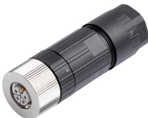
I dispositivi periferici dovrebbero essere alimentati con maggiore potenza. Con il nuovo connettore ad innesto M12 di Weidmüller, è possibile fornire oltre 250 V e 2 A senza problemi. I connettori M12 compatti codificati A, K, L, S e T sono progettati per la trasmissione di massimo 630 V AC o 60 V DC e 12 A.
