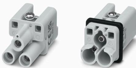
Serie HQ - Piccola nelle dimensioni, grande nelle prestazioni. Le caratteristiche elettriche parlano da sole. Il livello di collegamento cavo è ideato per le viti assiali. Questa tecnologia consente un collegamento del conduttore senza utensili speciali. È sufficiente una chiave a brugola semplice.
