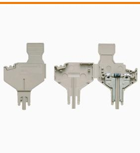
La spina per componenti viene utilizzata per integrare un componente elettronico in una morsettiera di sezionamento. Dopo aver saldato il componente elettronico, la spina può essere integrata nell'area di disconnessione dei nostri morsetti sezionatori e quindi cambia il morsetto sezionatore in un morsetto modulare con componente elettronico integrato.
