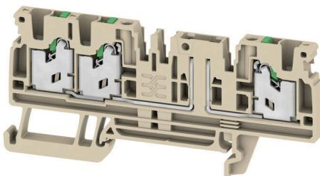
In alcune applicazioni è opportuno aggiungere un rilevatore di prova o un elemento di separazione al morsetto componibile passante per scopi di prova e sicurezza. Con i morsetti per sezionatori di prova potete misurare i circuiti elettrici in assenza di tensione. Sebbene la distanza dei punti di disconnessione e la distanza superficiale non siano valutate in termini dimensionali, deve essere dimostrata la forza di tensione impulsiva di dimensionamento specificata.
